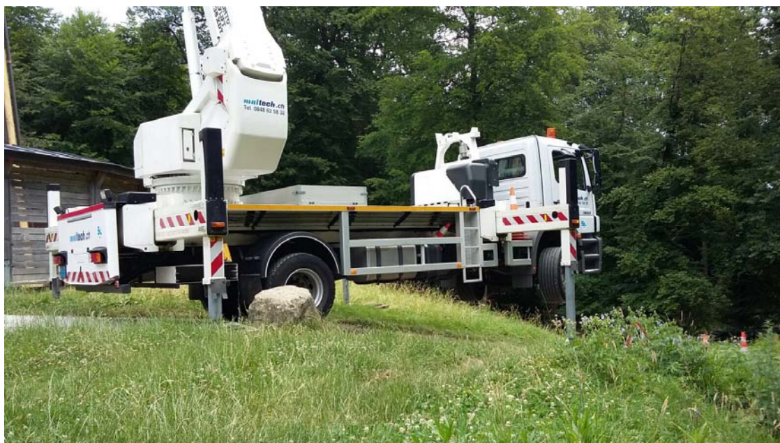
26.06.2017 camion avec chauffeur S38, hauteur max de la plateforme 36m de Maltech SA
